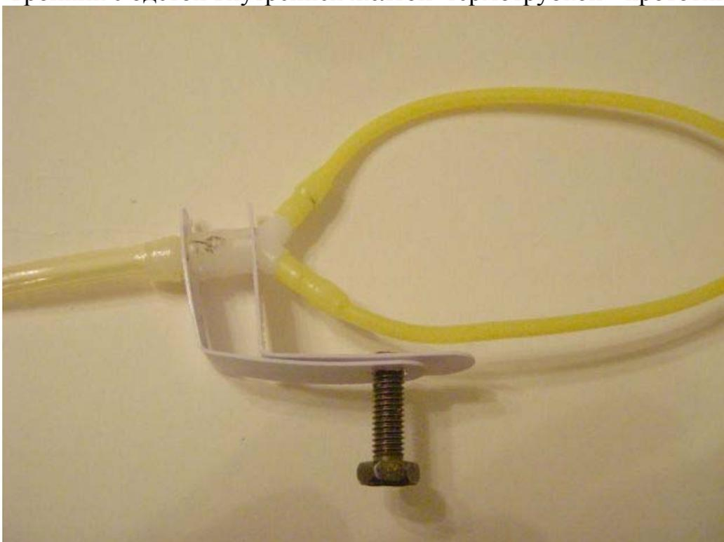
Вот смазчик - зеленая это вторая термотрубка и хорошо видна “Г” железяка, загнутый конец медной трубки закрепляющий тройник на железке и одетый толстый силикон от капельницы
