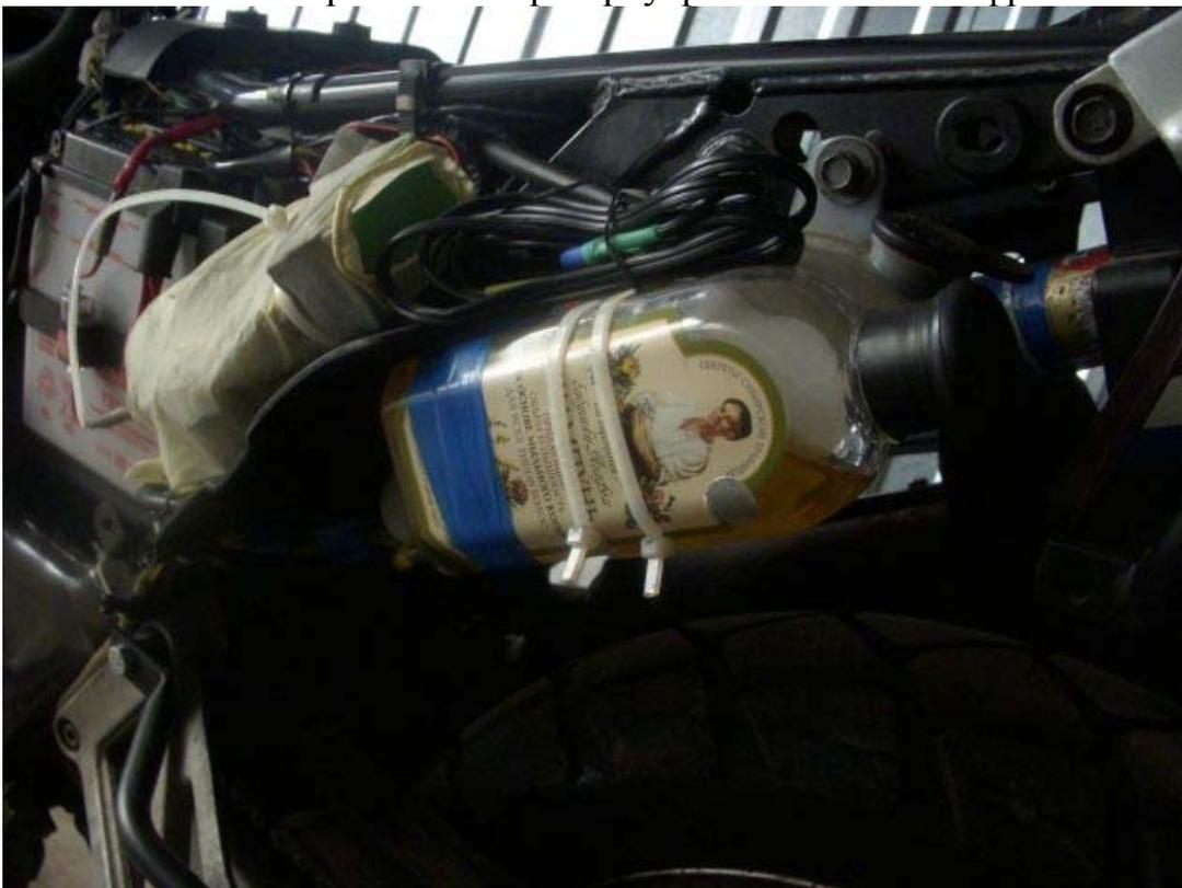
Тройник с одетой внутренней желтой термотрубкой - прототип смазчика
